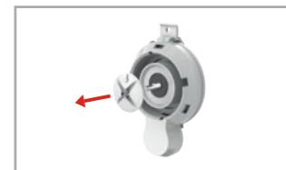
Demonteer en reinig de instantmixer. Raadpleeg "Instantmixer demonteren"! Zorg ervoor dat de instantmixer na het reinigen correct wordt teruggeplaatst.
