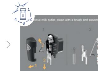
Die Teile ausbauen wie auf dem Display dargestellt, nach dem Hygienekonzept reinigen und wieder montieren. Befolgen Sie die detaillierte Anleitung „Demontage Milchauslauf / Kaffeeauslauf“ auf der Rückseite.
