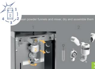
Die Teile ausbauen wie auf dem Display dargestellt, nach dem Hygienekonzept reinigen und wieder montieren. Befolgen Sie die detaillierte Anleitung „Demontage Instant-Mischeinheit“ auf der Rückseite.
