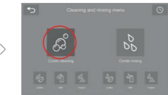
Appuyer sur la touche NETTOYAGE COMBI pour lancer la procédure de nettoyage.
