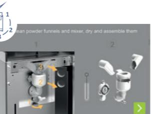
Démonter les pièces tel que décrit à l'écran, nettoyer selon le concept hygiénique et les remonter. Suivre les consignes détaillées « Démontage unité de mélange d'instantané » apposées sur la face arrière.
