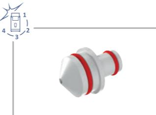
Die Dampfdüse im Milchaufschäumer demontieren und reinigen. Siehe „Demontage Milchauslauf“!
