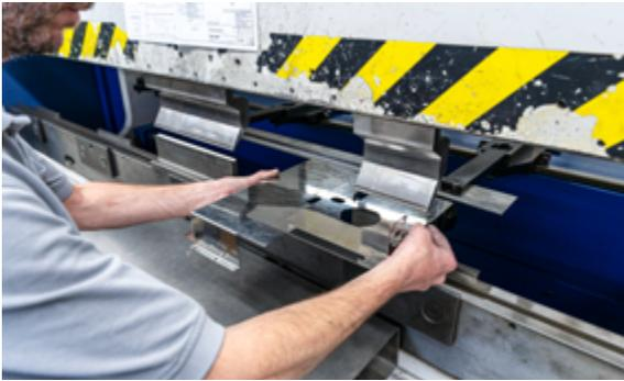
Ecken und Kanten, aber wohlgeformte, werden an der Abkantmaschine umgesetzt, während der Spenglerei-Mitarbeiter auch das Punktschweissen millimetergenau umsetzt.
